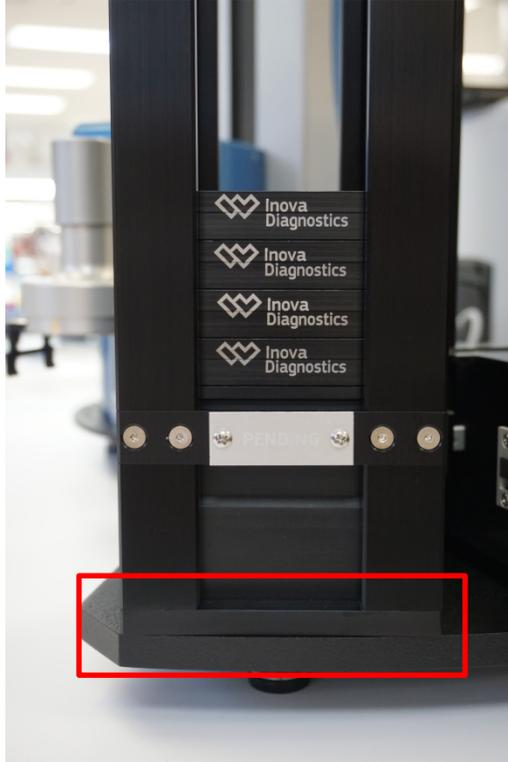
Abbildung A4-4 Stapel ist bündig auf der Stapelplatte
