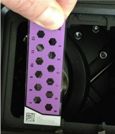
Abbildung 5-6a Objektträger in 4-Objektträger-Block laden
